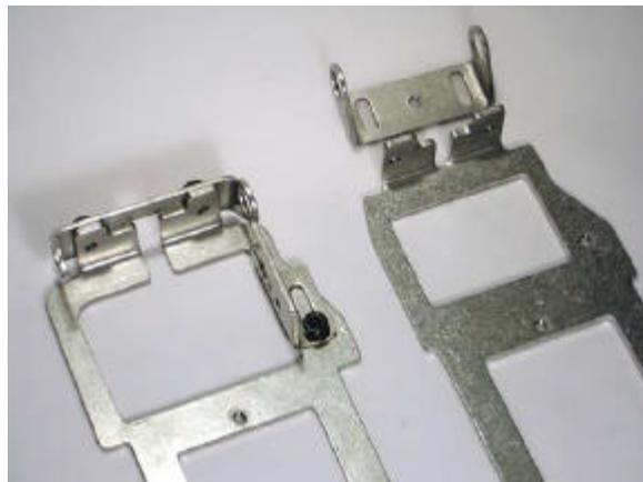
En el montaje, nos fijaremos que las suspensiones actúan correctamente, en caso contrario, si se traba la suspensión, aflojaremos ligeramente los tornillos que tienen los muelles y moveremos la placa, a fin de que los separadores y los muelles se asienten correctamente.
