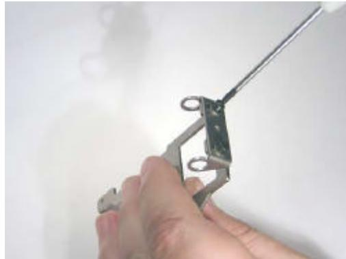
Después de realizadas estas operaciones, procederemos a montar la placa del soporte de motor. El chasis viene con dos soportes diferentes, un soporte para motor tipo Carrera Exclusiv 1/24, y el otro soporte para motores tipo NC2 o Falcon (es el que montaremos), la principal diferencia entre ellos esta en el agujero para el cojinete del eje del motor.
