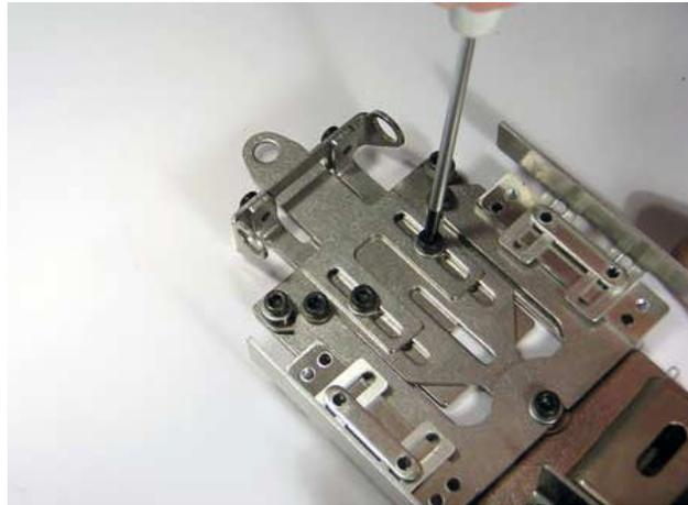
Otra posibilidad que debemos tener en cuenta, es que el soporte de eje delantero esta orientado hacia atrás, pero no hay ningún problema en orientarlo hacia delante. Eso si, siempre procuraremos atornillar por el lado contrario a donde esta el eje, de esta forma, cuando tengamos montado el eje, no nos estorbara para atornillar.
