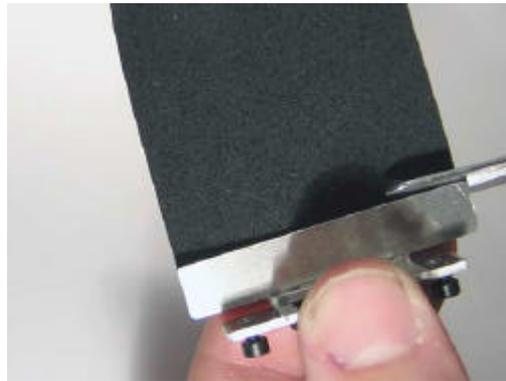
Una vez tenemos la banda, vamos a preparar la superficie del soporte donde se pegará. Para ello, con el mini taladro, lijamos ligeramente la superficie del soporte, para obtener una superficie rugosa, así el pegamento se adherirá mejor.
