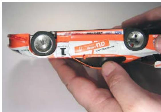
Una vez realizados estos ajustes, procedemos a montar la guía. Debemos tener en cuenta, que entre la guía y el soporte de guía del chasis, va una arandela de teflón que se suministra, al igual que la guía, con el chasis.
