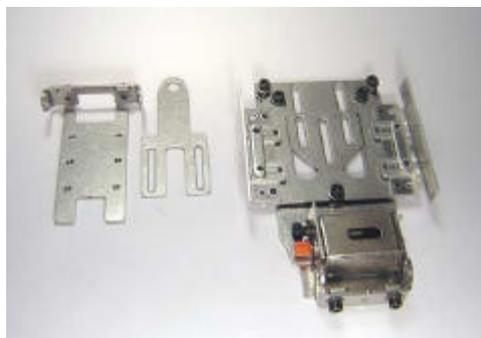
Podemos apreciar que la placa donde esta atornillado el soporte de eje delantero tiene seis agujeros roscados, la pieza con forma de V tiene dos orificios con forma alargada por cada lado y el soporte de guía tiene dos de estos orificios alargados.
