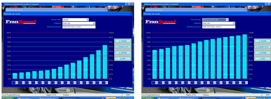
En la pantalla de la izquierda, tenemos la forma de la curva para un motor que tuviera una respuesta 100% proporcional (Default) y en la pantalla de la derecha tenemos la misma curva una vez seleccionado el motor para el cual queremos la curva.
